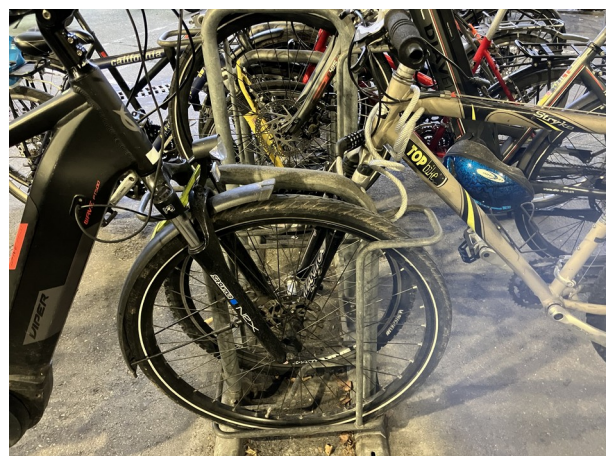
Figure 12: Attaches sur la roue avant, non recommandé
